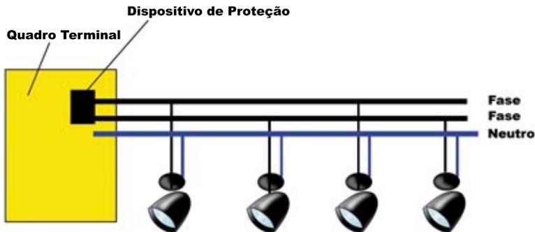
Figura 4: um circuito monofásico (ou bifásico) com três condutores vivos (FFN) alimentando equipamentos de iluminação ligados entre fase e neutro
