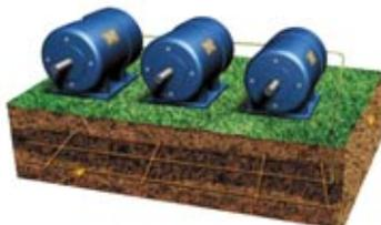
Figura 16: exemplo que ilustra o conceito de “eqüipotencialização”: as massas M são colocadas no mesmo potencial entre si, mas podem estar em um potencial diferente em relação ao eletrodo de aterramento.
