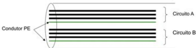
Figura 28: caso em que cada circuito tem seu próprio condutor de proteção (PE)
