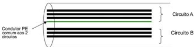
Figura 29: caso em que cada o condutor de proteção (PE) é comum a mais de um circuito
